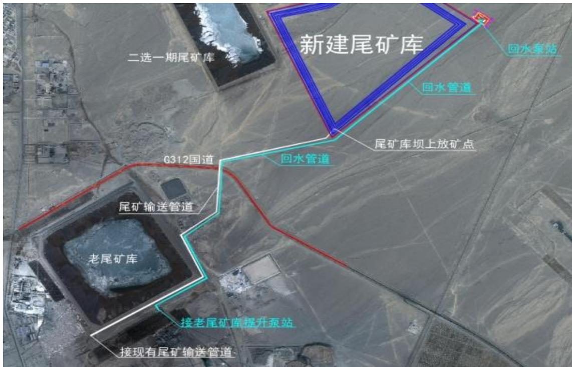
图 2-3 尾矿输送管道及回水管道路
