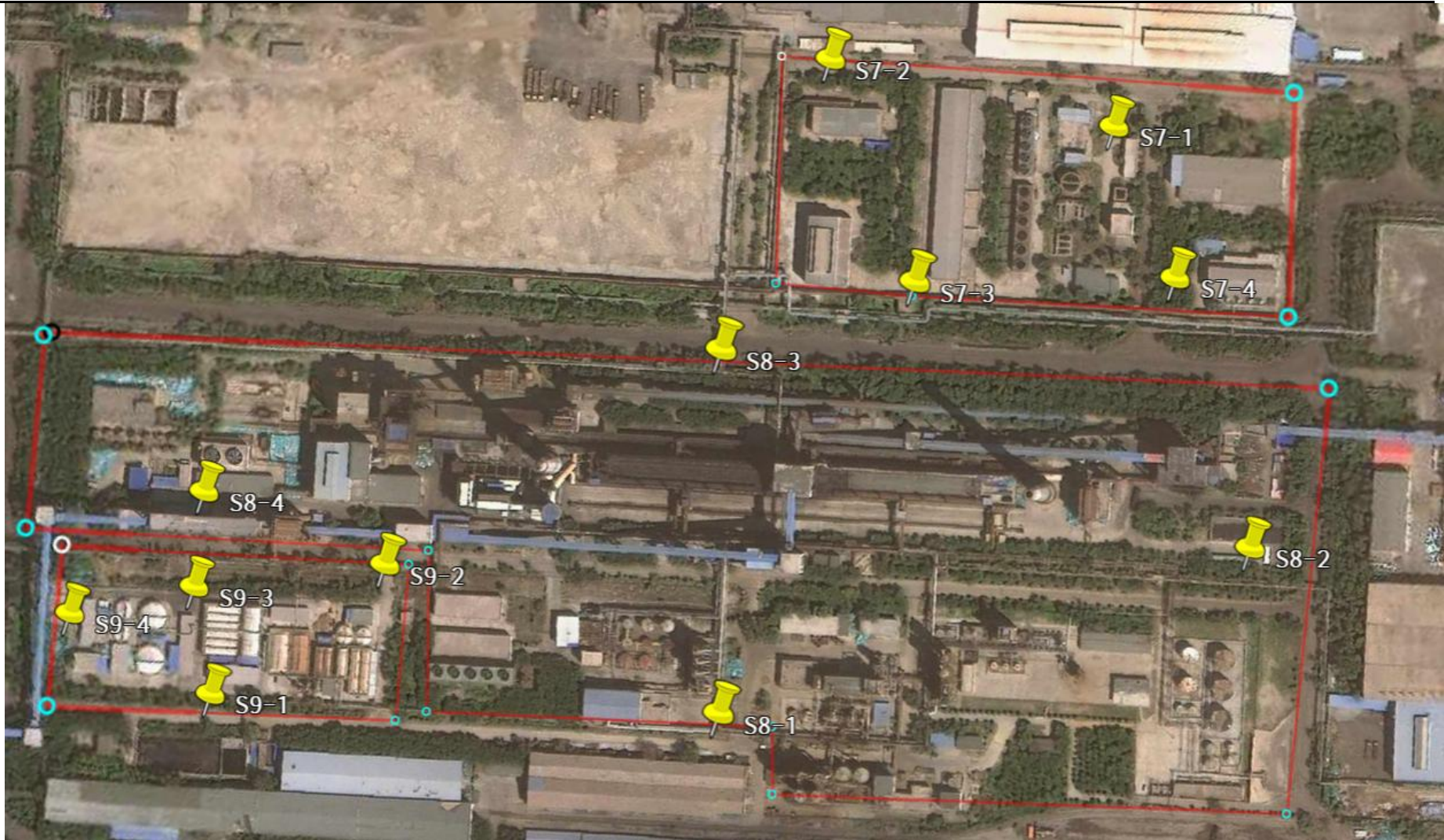
图4 榆钢场地现状调查监测点位图 (S8:焦化工序、S9:酚氰废水处理站、S7:二期污水处理工序)
