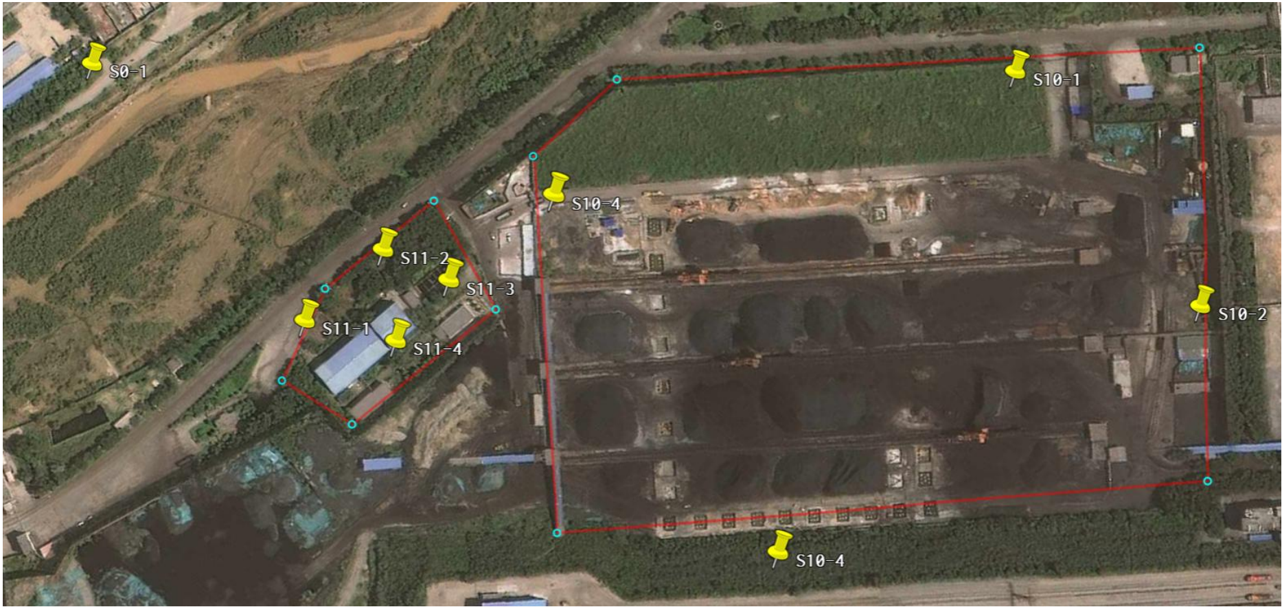
图5 榆钢场地现状调查监测点位图 (S11:一期原料场、S10:一期污水处理站、S0:背景对照点)
