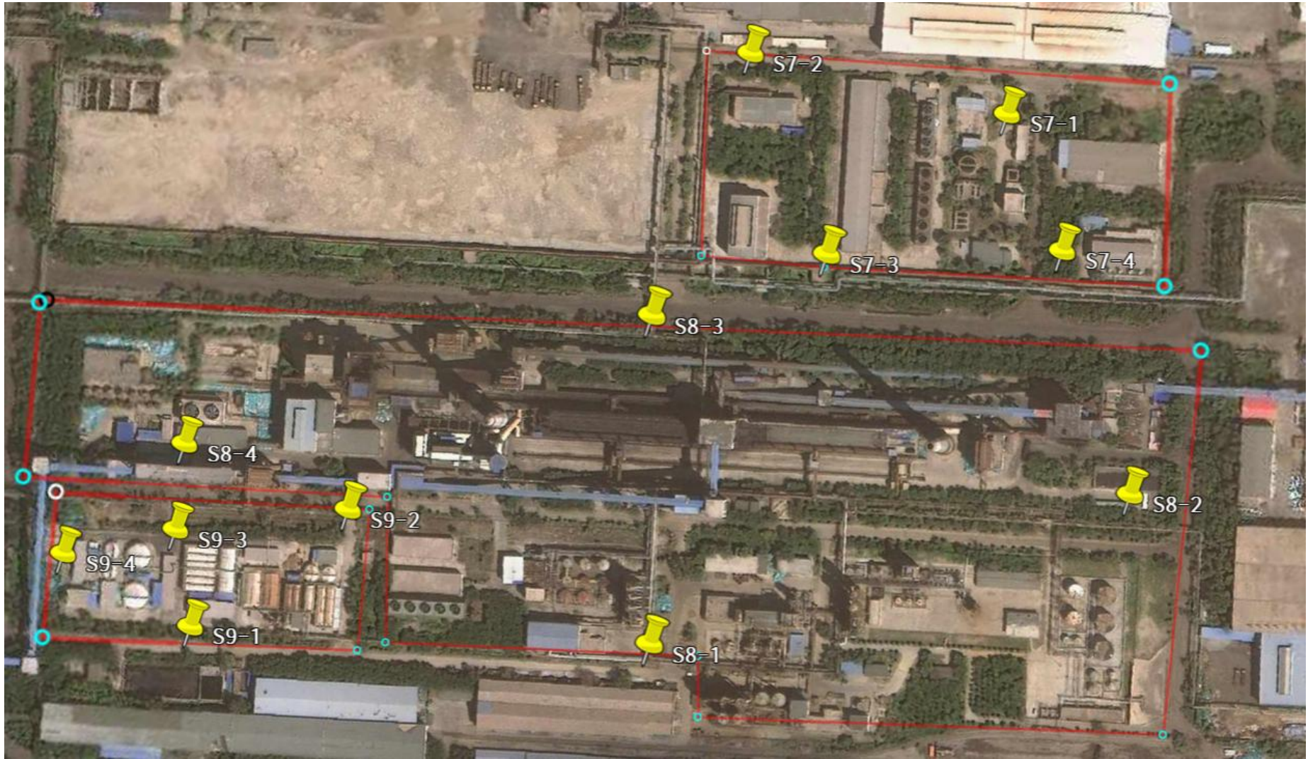
图4 榆钢场地现状调查监测点位图 (S8:焦化工序、S9:酚氰废水处理站、S7:二期污水处理厂)
