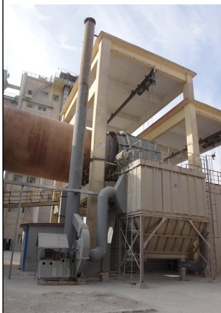
图 3 冷却口除尘设备
