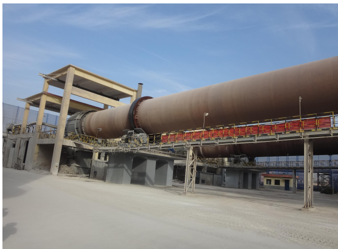
图 9 回转窑窑体
