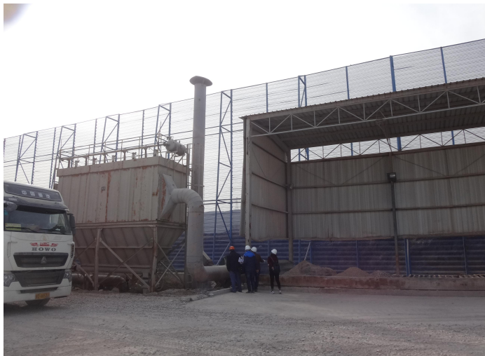
图 7 卸矿槽除尘设备
