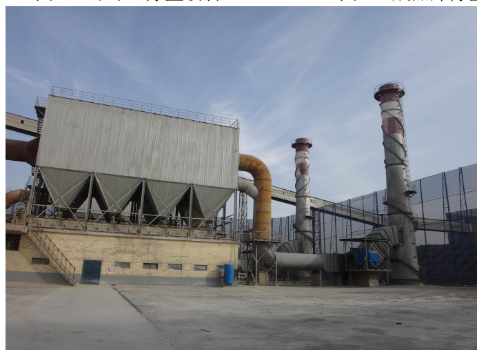
图 5 窑尾除尘设备
