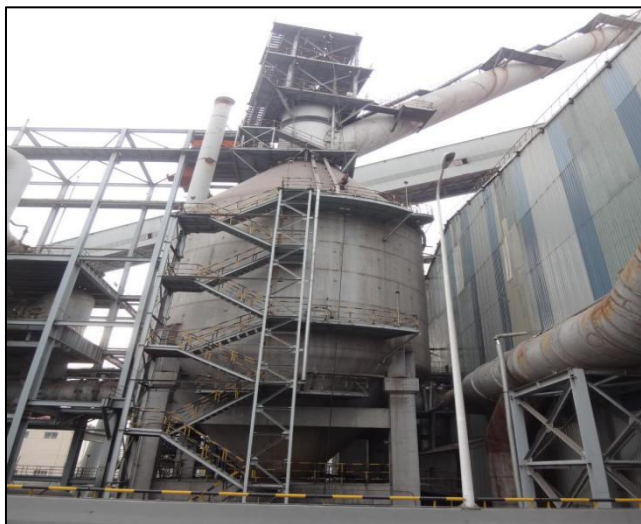
高炉煤气重力除尘器
