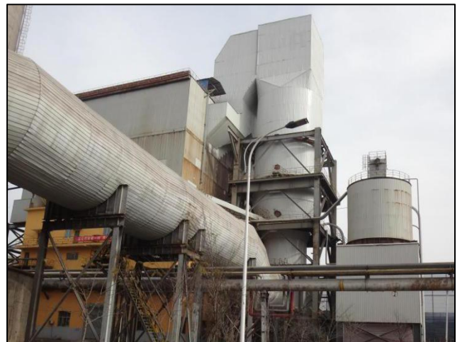
半干法脱硫系统脱硫塔
