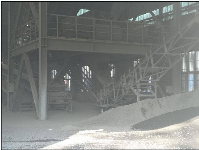
转炉钢渣粒化、磁选线
