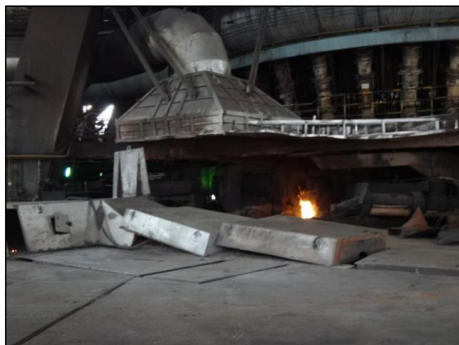
高炉铁水出口集气罩
