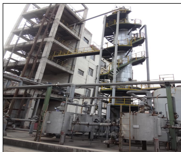
硫酸干燥塔除尘器
