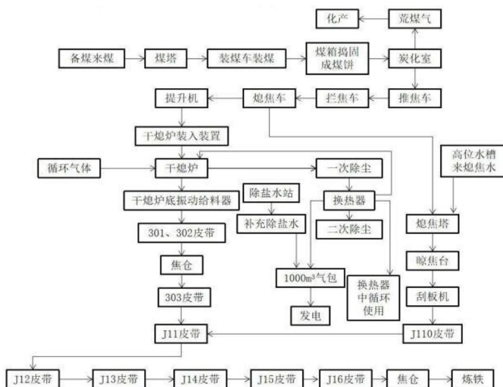
图 2-12 三炼焦生产工艺流程图
